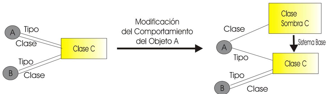
**Figura 3.21: Creación dinámica de una clase sombra en *MetaXa* para modificar el comportamiento de una instancia de una clase**
